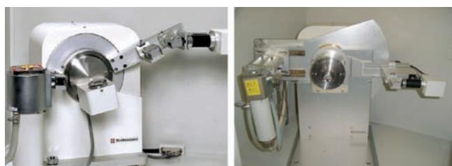
写真2 縦型ゴニオメータと試料水平型ゴニオメータ
