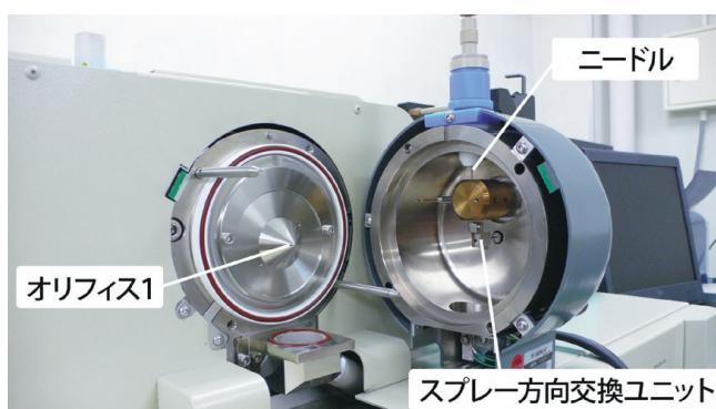
図2 イオン源の構造
