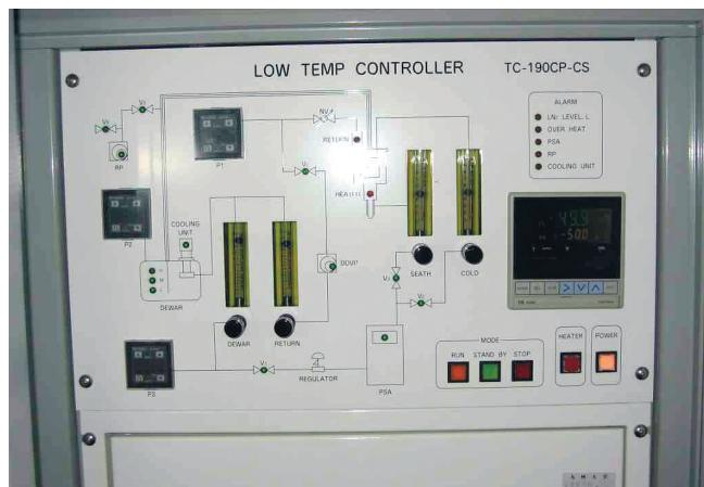
図3 液体窒素自動製造装置
